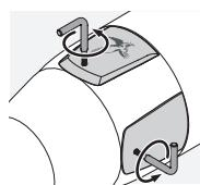
2. Крышки механизмов коррекции по высоте и боковой коррекции отвинтите с помощью прилагаемой отвертки Torx (TX 6). После этого при открытых крышках с помощью установочного инструмента выполните коррекцию по высоте и боковую коррекцию.
