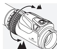
Otačaním (voľným) zväčšovacieho prstence si môžete nastaviť požadované zväčšenie v rozsahu 180°. Stupnica umožňuje jednoducho prečítať hodnoty nastavenia.
